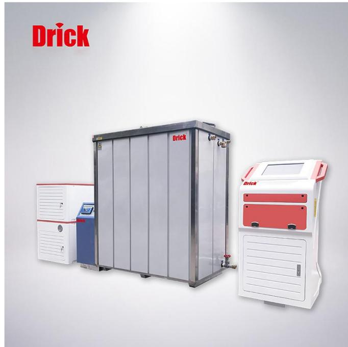
XGNB 系列塑料管材耐压爆破试验机，软件界面内容更适合国情，具有很高的性价比。采用 airless 型压力系统，使用安全可靠、控制精度高。根据需要一台主机可选多路压力，任一试样爆裂立即自动关闭该路。长时自动连续运行，其关键件均选用进口产品。整机性能达到进口同类产品水平。塑料管材耐压爆破试验机为我国的各级化学建材检测行业、产检所及塑料管材生产厂提供具有国际先进水平的国产化检测仪器。塑料管材耐压爆破试验机系列机型采用微机控制技术，具有试验参数设定存储，显示打印曲线，实时分析，实验报告输出等功能。软件运行 Windows 系统下，可根据国家标准，国际标准或用户提供的标准检测和判断各种管材的长期静液压性能及瞬时爆破试验，并对实验数据进行分析处理，打印输出。
