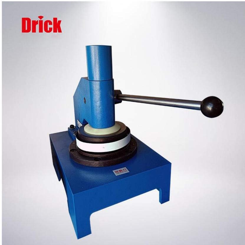
DRK110-1 可勃吸收性取样器（以下简称取样器）是纸张、纸板吸水性及透油度测定标准试样的专用取样器。是造纸、包装、科研和质量监督检验等行业和部门理想的辅助试验器具。
