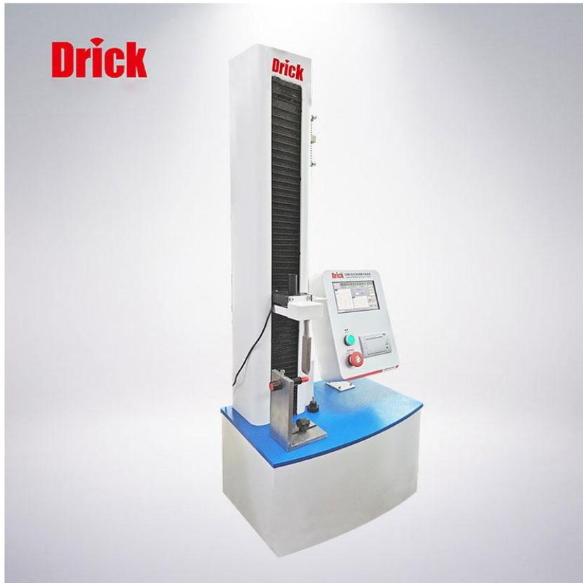
DRK101 触控彩屏口红折断力测试仪 (以下简称测控仪) 采用最新 ARM 嵌入式系统, 800X480 大液晶触摸控制彩色显示屏, 放大器、A/D 转换器等各器件都采用最新技术, 具有高精度、高分辨率的特点, 模拟微机控制界面, 操作简单方便, 极大提高试验效率。性能稳定、功能齐全, 设计采用多重保护系统 (软件保护和硬件保护), 更可靠更安全。
