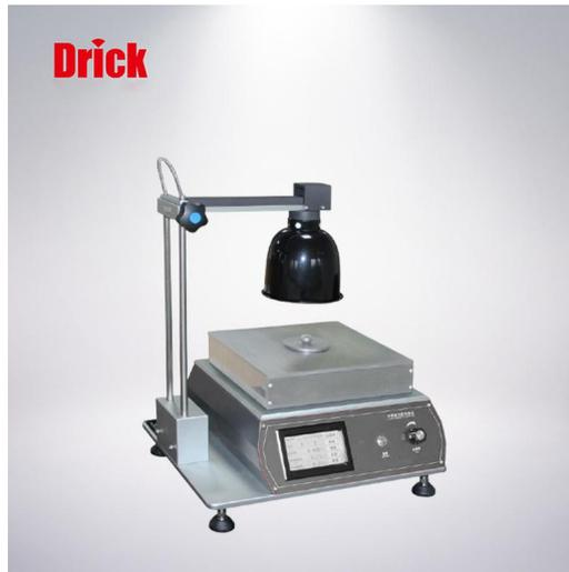
DRK3000A 遮光率实验仪，设备依据 FZ/T62025-2015 等标准研发制造，用于测定织物在一定的强光照射下，光线透过试样的发光照亮，与无试样时的照度相比较计算出遮光率。
