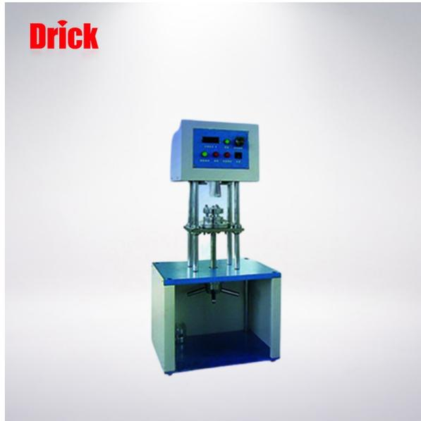
ZWS-0200 压缩应力松弛仪用于硫化橡胶压缩应力松弛性能的测定，特别适用于作为密封材料的橡胶制品的应用研究，符合 GB1685《硫化橡胶在常温下和高温下压缩应力松弛的测定》、GB/T 13643《硫化橡胶或热塑性橡胶压缩应力松弛的测定 环状试样》等标准的要求。压缩应力松弛仪结构简单、操作方便、数字显示压缩力值，直观可靠，应用十分广泛。
