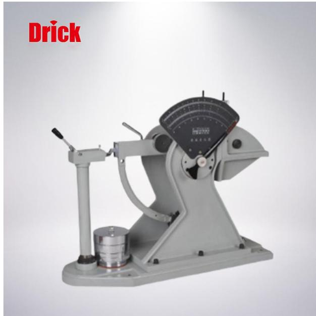
DRK104A 纸板戳穿试验仪是瓦楞纸板抗戳穿性能(即戳穿强度)测定的专用仪器。仪器具有快速压紧、操作手柄自动复位及安全防护可靠等特点，其测试精度高，性能可靠，是纸箱生产厂、科研及质量监督检验等企业和部门不可缺少的常用仪器。
