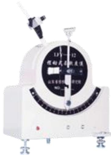
适用于测定织物、领衬布、无纺布、人造革的刚柔性能，也适用于测定尼龙、塑料线、编织袋等非金属材料的刚柔性。
